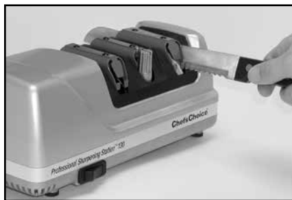
Obrázek 10. Ostření vlnitého ostří jen ve 3. stupni
