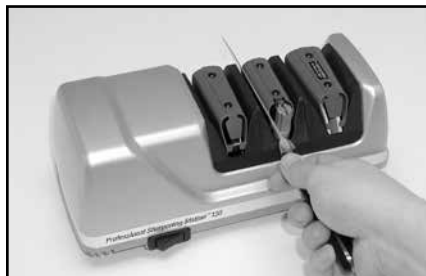
Obrázek 8. Ostří je nutno tvrdit střídavě v pravém a levém otvoru
